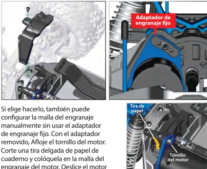
Si elige hacerlo, también puede configurar la malla del engranaje manualmente sin usar el adaptador de engranaje fijo. Con el adaptador removido, Afloje el tornillo del motor. Corte una tira delgada de papel de cuaderno y colóquela en la malla del engranaje del motor. Deslice el motor y el piñón del engranaje cilíndrico.
