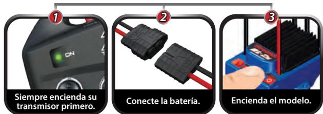
• Utilice siempre baterías nuevas o recién cargadas para el sistema de radio. Las baterías con poca carga limitarán la señal de radio entre el receptor y el transmisor. La pérdida de señal de radio puede hacer que pierda el control de su modelo.
