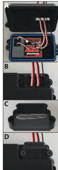
El excedente de ESC y de los cables de servo deben enrollarse dentro de la caja del receptor. Tire hacia afuera todo el cable de antena disponible de la caja del receptor.
